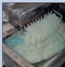
Stap 3. Links: spoelen van EPC + losgewerkte materiaal met PP naturel; rechts: het einde van stap 3.
